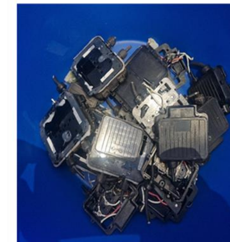
Scatole di giunzione
